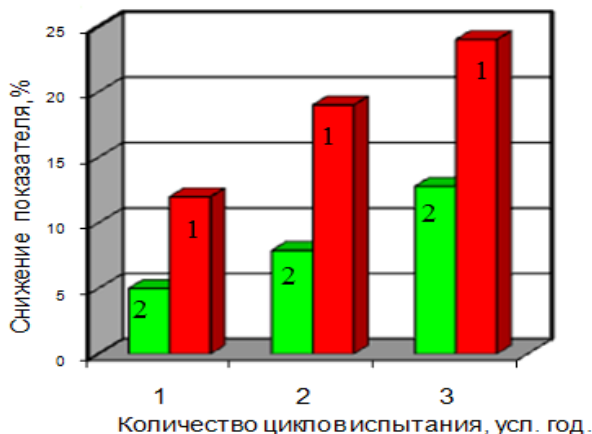
Рис. 4. Изменение водостойкости образцов асфальтобетона: исходный битум (1) и битум, модифицированный СВЧ полем (2)
