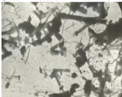
Рис. 1. Структура композита на основе мартеновского шлака
