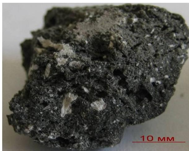
Рис. 3. Образование устойчивых сгустков дефеката в матрице силикат-натриевого связующего
