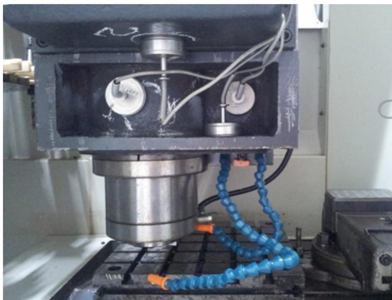
Рис. 2. Вид установленных термодатчиков в эксперименте
