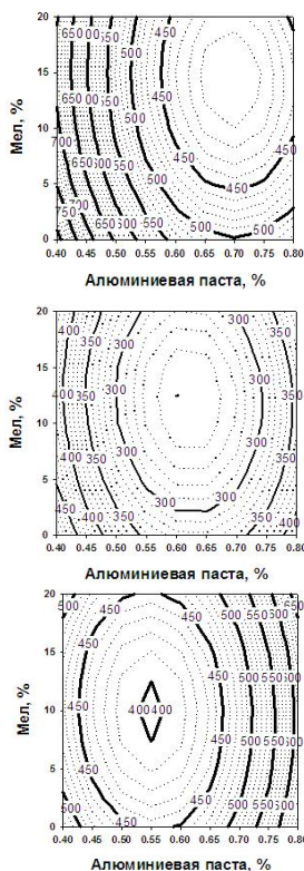
Рис. 1. Зависимость средней плотности газобетона на композиционном вяжущем от В/Т, количества алюминиевой пасты и мела: 1 – В/Т = 0,45; 2 – В/Т = 0,55; 3 – В/Т = 0,65
