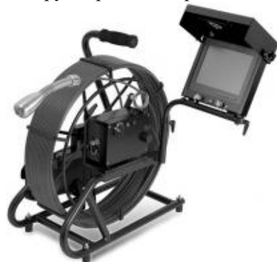
Рис. 6. Общий вид оборудования видеодиагностики и изображение состояния трубопровода на экране монитора
