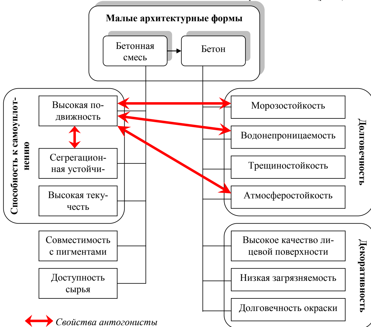
Рис. 1. Требования к бетонным смесям и бетонам для МАФ
