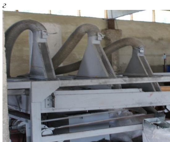
Рис. 2. Оборудование технологической линии по переработке изношенных автомобильных шин: а – решетка вибратора для отделения текстиля и крупных включений из общей массы продуктов переработки; б – механизм подачи резиновой крошки для последующего разделения по фракциям; в – сита просеивателя; з – пылеуловитель с системой сит
