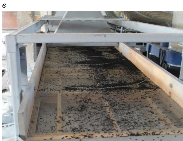
Рис. 2. Оборудование технологической линии по переработке изношенных автомобильных шин: а – решетка вибратора для отделения текстиля и крупных включений из общей массы продуктов переработки; б – механизм подачи резиновой крошки для последующего разделения по фракциям; в – сита просеивателя; з – пылеуловитель с системой сит
