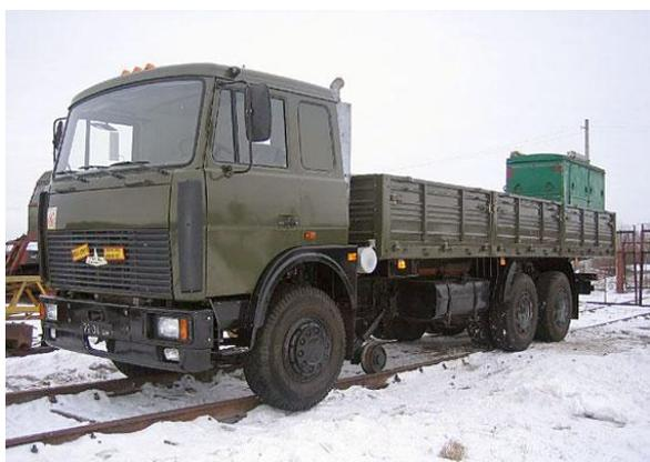
Рис. 4. Автомобиль МАЗ-6303 на комбинированном ходу
