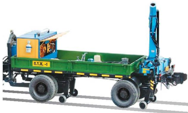
Рис. 5. Прицеп тракторный железнодорожный ПТЖ-1
