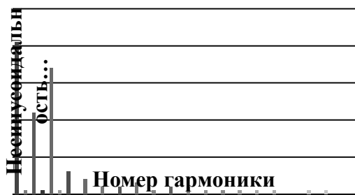
Рис. 7. Гармонические составляющие тока энергосберегающей лампы
