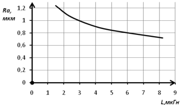
Рис.2 График зависимости шероховатости от индуктивности при энергии импульсов E = 641\text{мкДж}
