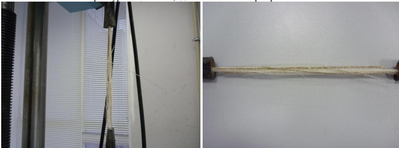
Рис. 3. Характер разрушения композитной арматуры
