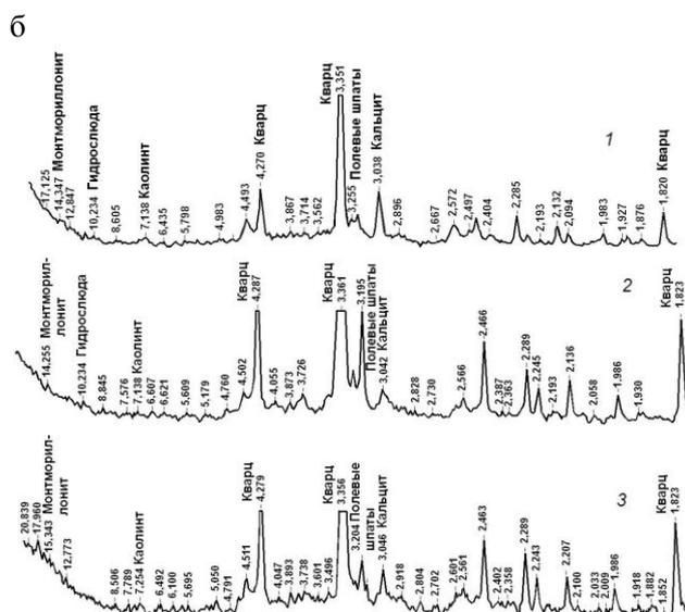
Рис. 1. Термограммы (а) и рентгенограммы (б) песчано-глинистых пород: 1 – супесь; 2 – суглинок № 1; 3 – суглинок № 2
