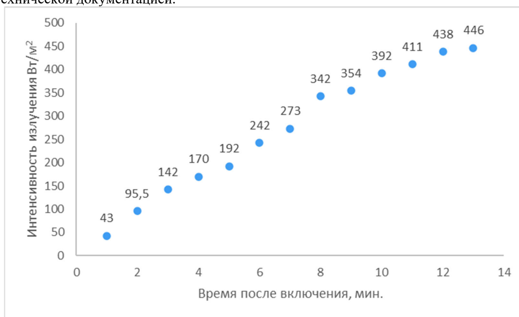
Рис. 2. Рост интенсивности излучения после включения обогревателя.
