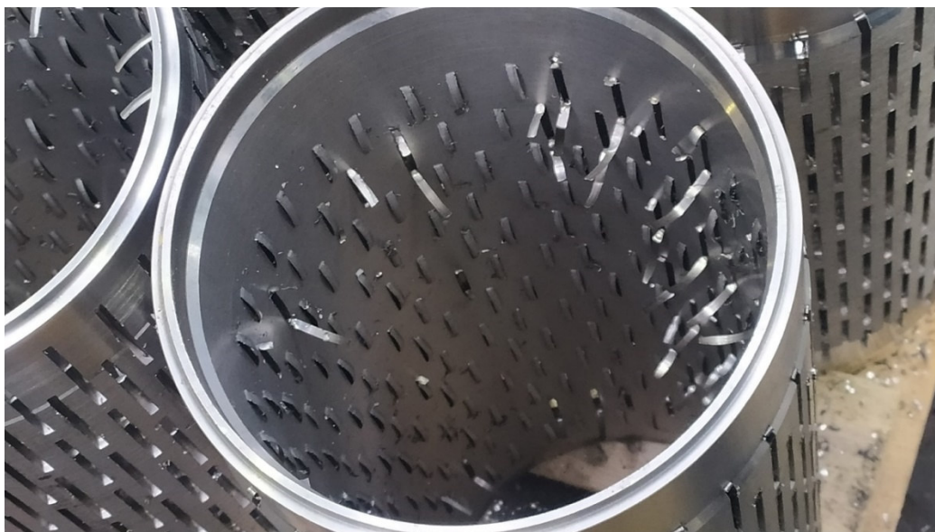
Рис. 4. Дефекты в виде заусенцев внутри детали
