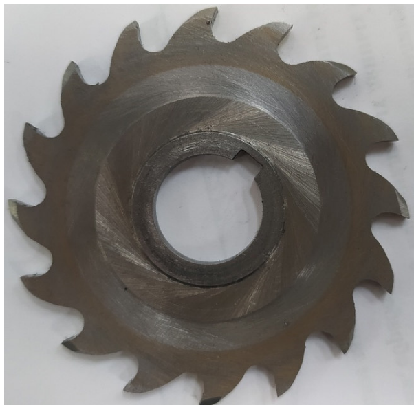
Рис. 2. Износ фрезы общий вид
