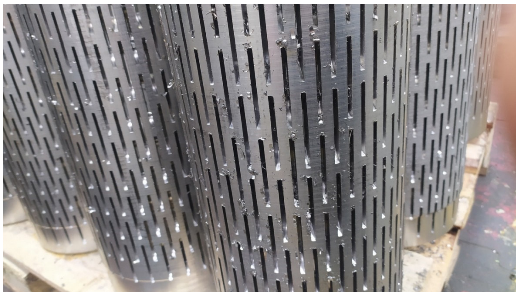
Рис. 5. Выступы в виде заусенцев снаружи детали
