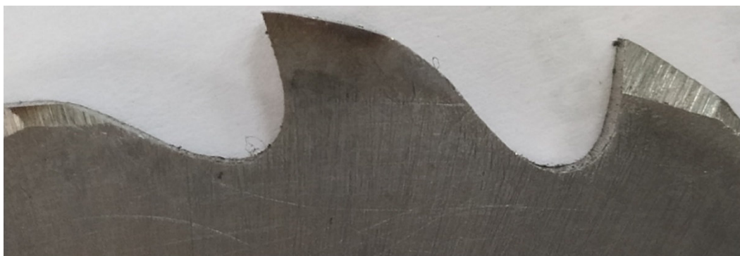
Рис. 3. Износ режущего зуба фрезы
