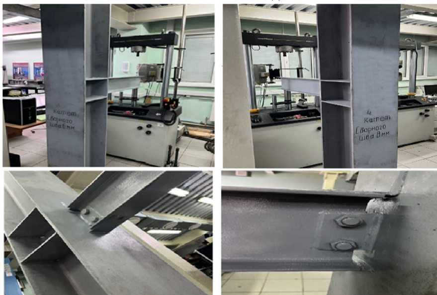
Рис. 3. Образец № 3 с катетом швом 6 мм, образец № 4 с катетом швом 8 мм
