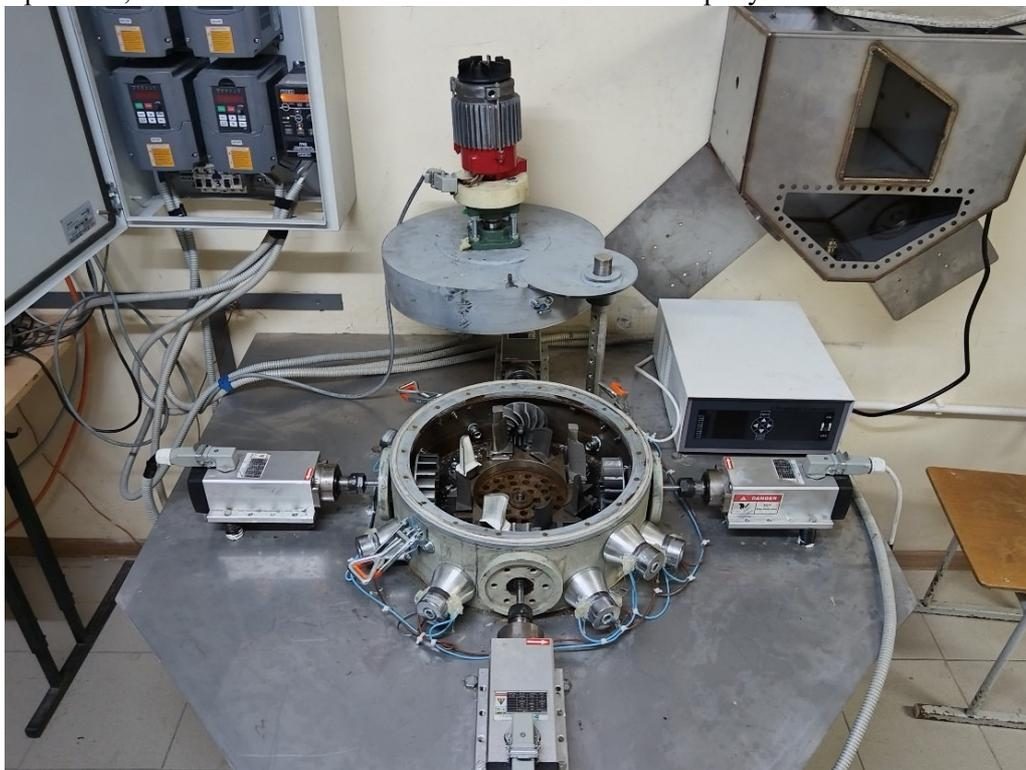
Рис. 4. Оборудование для реализации отделочной обработки с применением эффекта вихревой кавитации с наложением комбинированного ультразвукового или электроэрозионного воздействия
