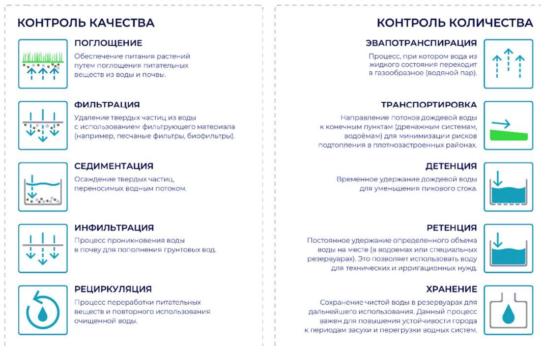
Рис. 4. Классификация методов водосберегающего проектирования. Разраб. Дубино А.М.
