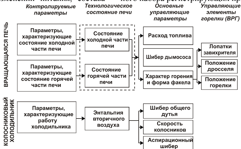
Рис. 1. Декомпозиция вращающейся печи и колосникового холодильника
