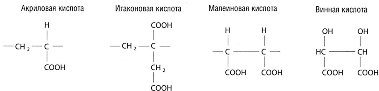
Рис. 3. Структурные формулы кислот, используемых в жидкости затвердения СИЦ [20]
