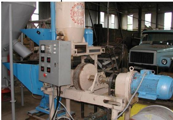
Рис. 2. Пресс-валковый экструдер новой конструкции
