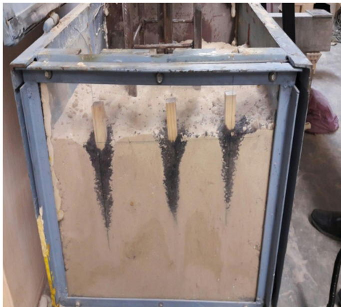
Рис. 12. Характер распределения наполнителя (выкрашен в черный цвет) вокруг моделей свай с «карманами» в процессе забивки
