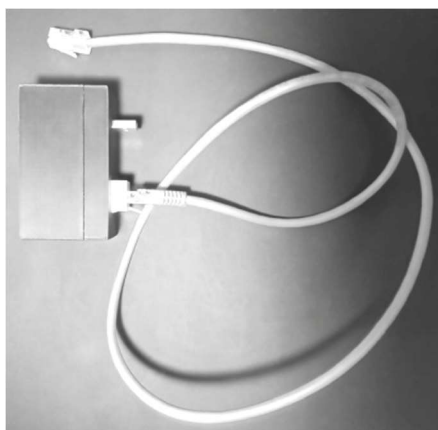
Рис. 6. Преобразователь интерфейса USB в интерфейс шин модулей системы управления с максимальным значением напряжения сигнала 3,3 В
