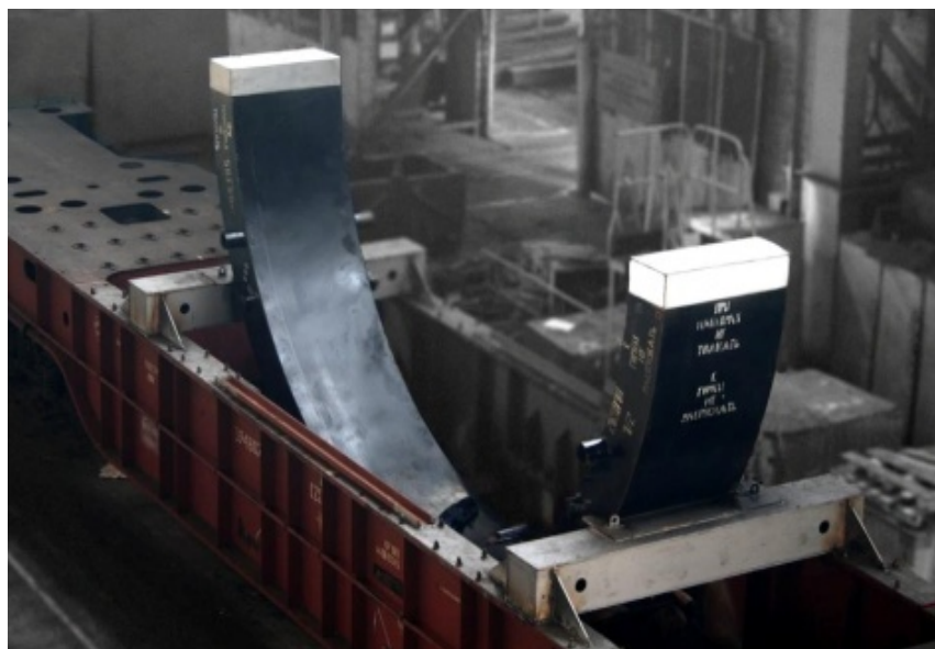
Рис. 2. Часть бандажа, подготовленная к транспортированию [Щетинин Н. А. Процесс и оборудование для реконструкции бандажей вращающихся печей: диссертация ... кандидата технических наук: 05.02.13; [Место защиты: Белгородский государственный технологический университет им. В.Г. Шухова]. Белгород, 2014. 204 с.]
