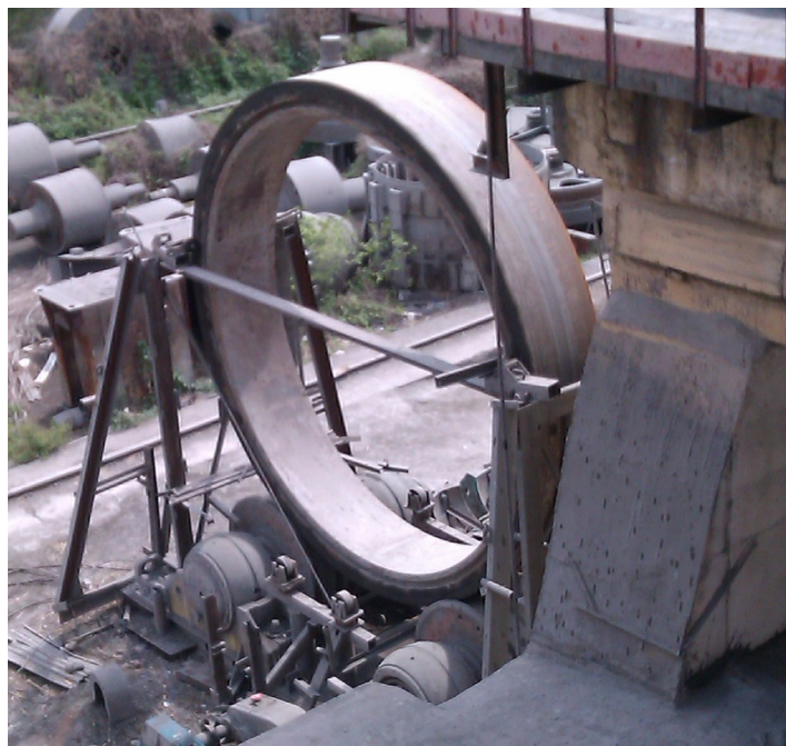
Рис. 4. Установка для исправления формы поверхностей бандажа [Щетинин Н. А. Процесс и оборудование для реконструкции бандажей вращающихся печей: диссертация ... кандидата технических наук: 05.02.13; [Место защиты: Белгородский государственный технологический университет им. В.Г. Шухова. Белгород, 2014. 204 с.]
