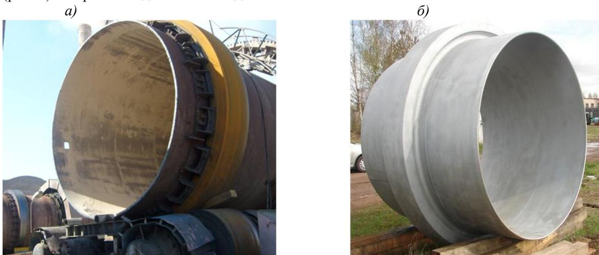
Рис. 1. Конструкции бандажей, применяемых на опорах вращающейся ТБ:
