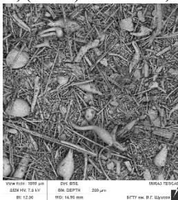
Рис. 2 - Микросъемка базальтовых волокон после их измельчения в ВЦА ( t=5 мин, \times 200 )
