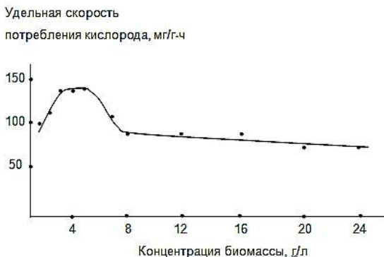
Рис. 1 - Зависимость удельной скорости потребления кислорода от концентрации биомассы, иммобилизованной на лавсановых ершах
