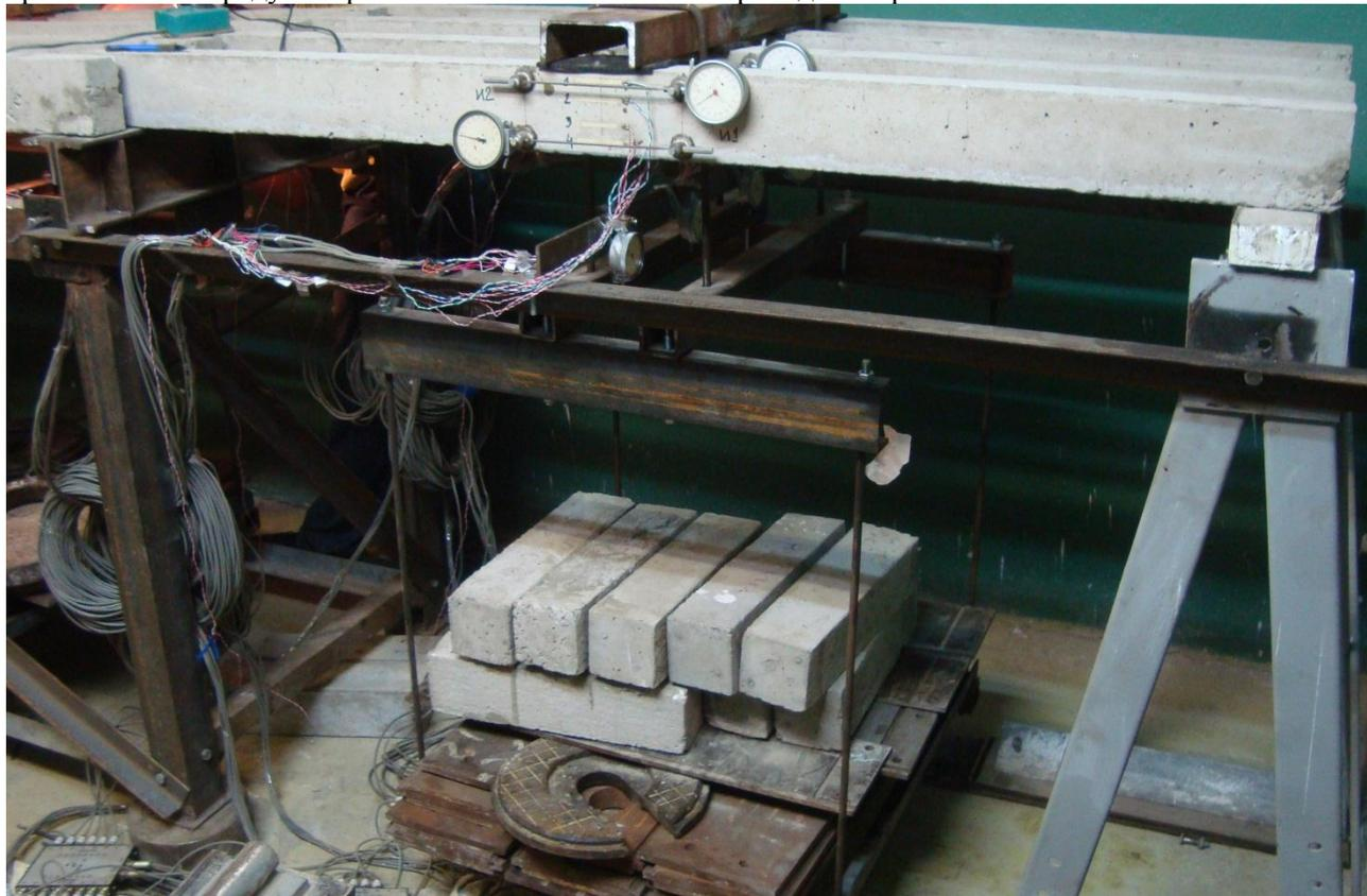
Рис. 2. Испытательный стенд для нагружения опытных образцов железобетонных балок
