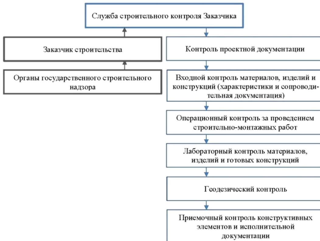
Рис. 1. Структурная схема контроля заказчика строительства
