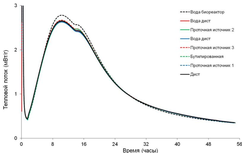
Рис. 2. Тепловыделение образцов с различной водой затворения
