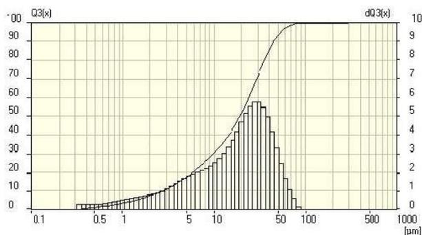
Рис. 1. Гранулометрический состав цемента
