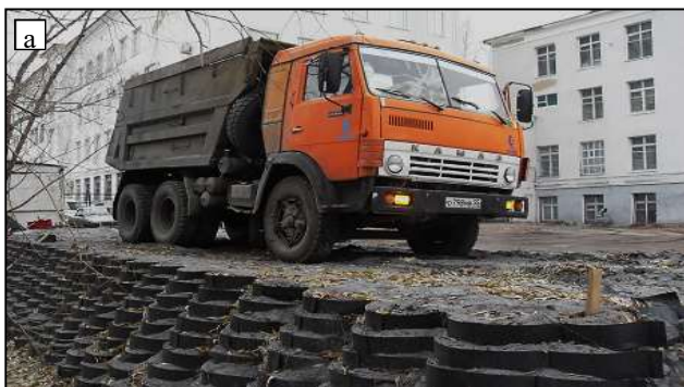
Рис. 2. Проведение штамповых испытаний на поверхности земляного полотна из ЗШС: а – установленный на насыпе автомобиль; б – измерение осадок штампа при нагружении
