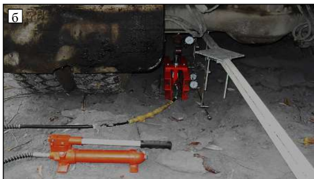
Рис. 2. Проведение штамповых испытаний на поверхности земляного полотна из ЗШС: а – установленный на насыпе автомобиль; б – измерение осадок штампа при нагружении
