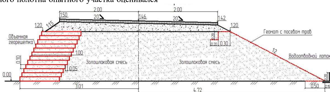
Рис. 1. Поперечный профиль дорожной конструкции опытного участка
