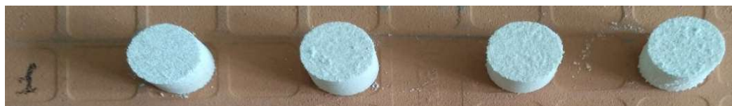
Рис. 2. Отпрессованные термообработанные таблетки шихты
