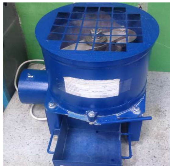
Рис. 2. Бетоносмеситель лабораторный БЛ-10
