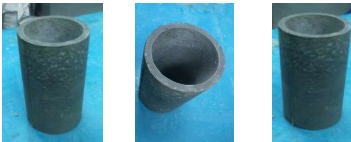
Рис. 3. Образцы из центрифугированного бетона перед тепловлажностной обработкой
