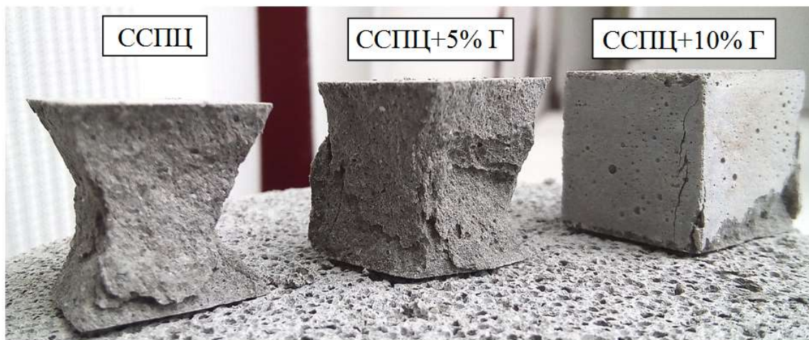
Рис. 3. Характер разрушения образцов при испытании на прессе
