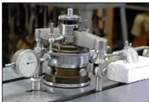
Рис. 4. Сдвиговый прибор конструкции института «Гидропроект»
