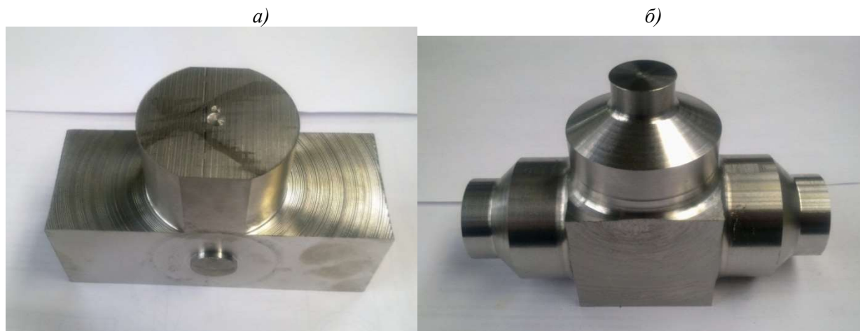
Рис. 1. Тройник по ОСТ24.125.16-89: а – заготовка; б – деталь после операции точения
