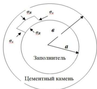
Рис. 1. Схема деформаций цементного камня при усадке:
