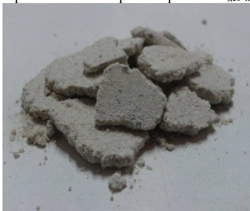
Рис. 2. Форма шлака после обработки давлением в ПВИ
