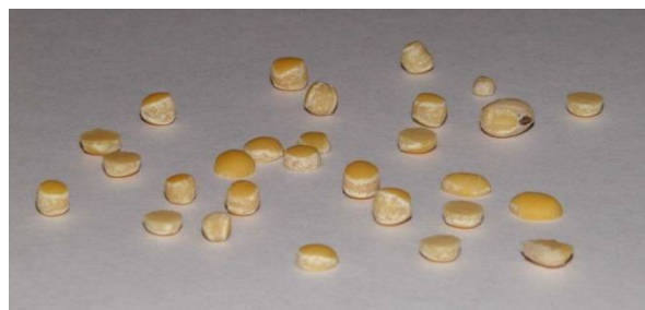
Рис. 3. Сферические частицы после обработки в камере измельчения
