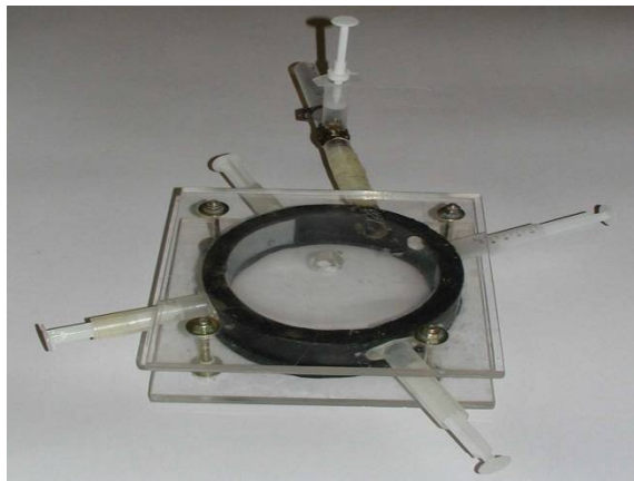
Рис. 2. Лабораторная установка для визуализации процессов в камере измельчения
