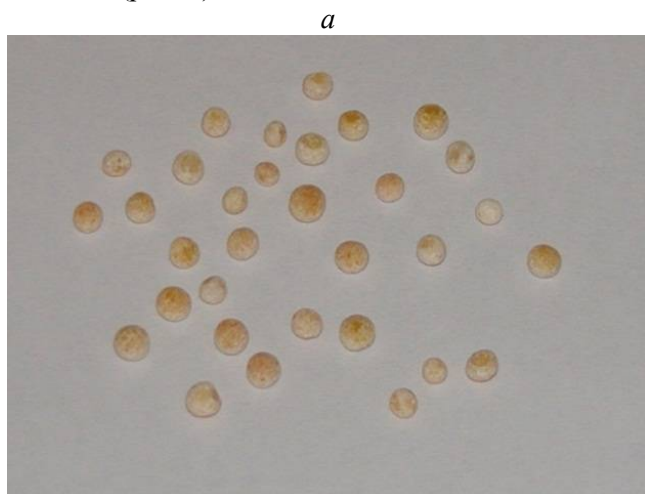
Рис. 4. Частицы после обработки в камере измельчения: a – сферические; б – пластинчатые
