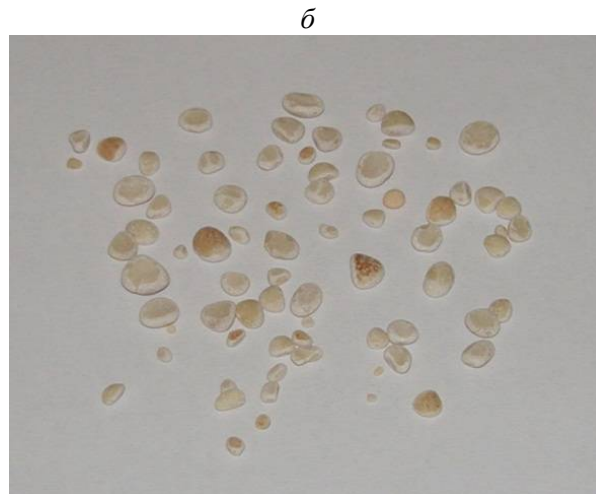
Рис. 4. Частицы после обработки в камере измельчения: a – сферические; б – пластинчатые
