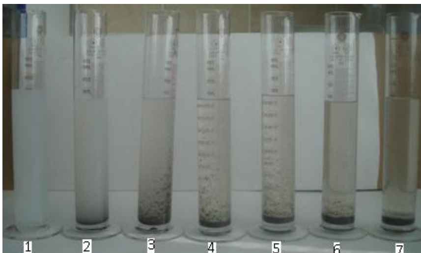
Рис. 10. Осветление суспензии глины через 24 часа с начала отстаивания (обозначения цилиндров указаны в табл. 5)
