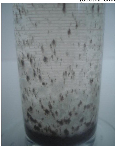
Рис. 11. Осветление суспензии глины через 1 час с начала отстаивания с добавкой коагулирующей суспензии – 1,5 мл на 250 мл глиняной суспензии
