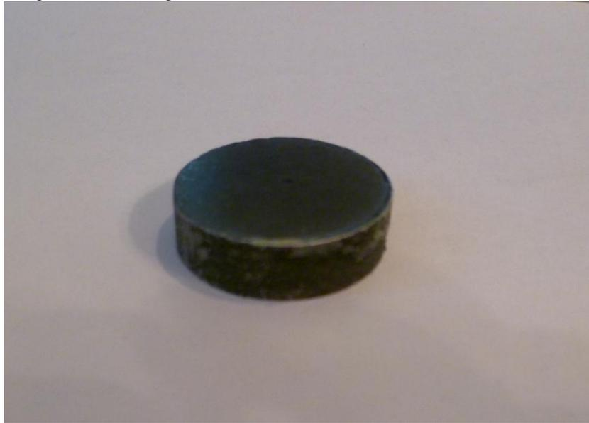
Рисунок 1. Внешний вид лабораторного образца высококонструкционного неорганического радиационно-защитного металлокомпозиционного материала на основе высокодисперсного железоксидного наполнителя (гематита  $\text{Fe}_2\text{O}_3$ ), оксида висмута и дюралевой матрицы
