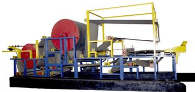
Рис. 1. Линия для производства туалетной бумаги
