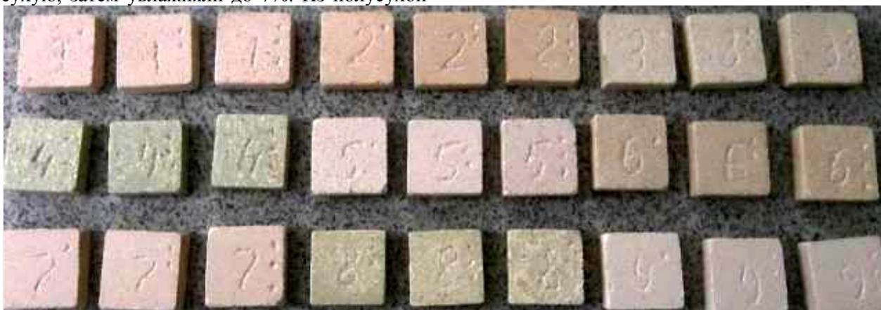
Рис. 1. Внешний вид плиток 1-й серии после обжига
