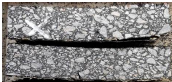
Рис. 2. Вид образца-балочки, выполненной с нарушением требований (без эмульсии, серия № 2), в момент разрушения
