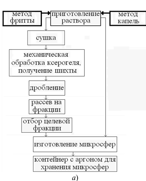
Рис. 1. Технологическая схема изготовления стеклянных микросфер:
