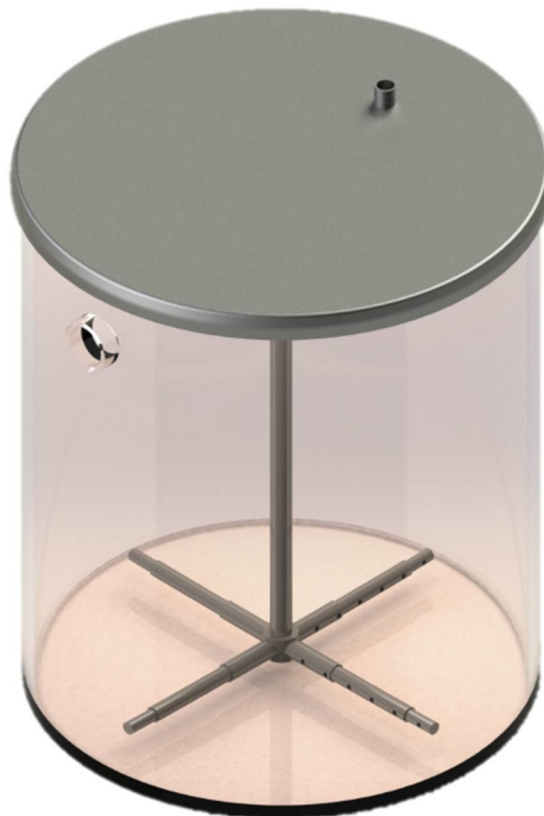
Рис. 1. Модель биореактора с мешалкой
