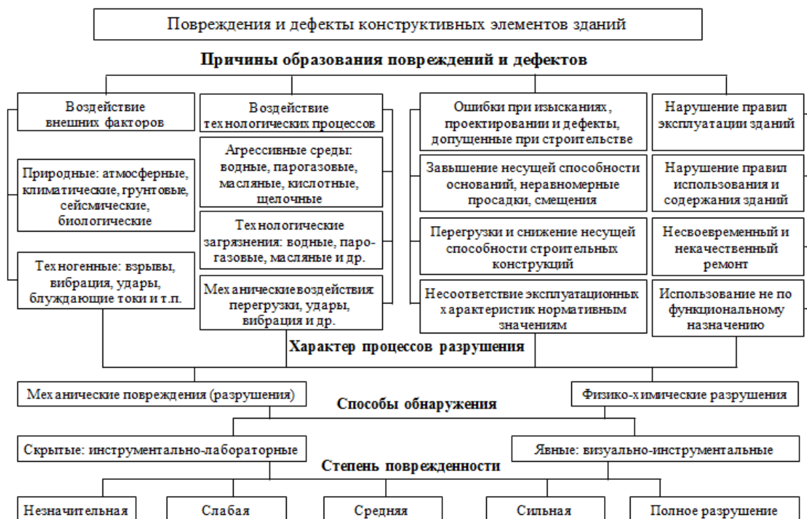
Рис. 2. Классификация повреждений и дефектов зданий
