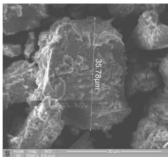
Рис. 2. Микростроение фрагмента отходов после нейтрализации. Увеличение 5000
