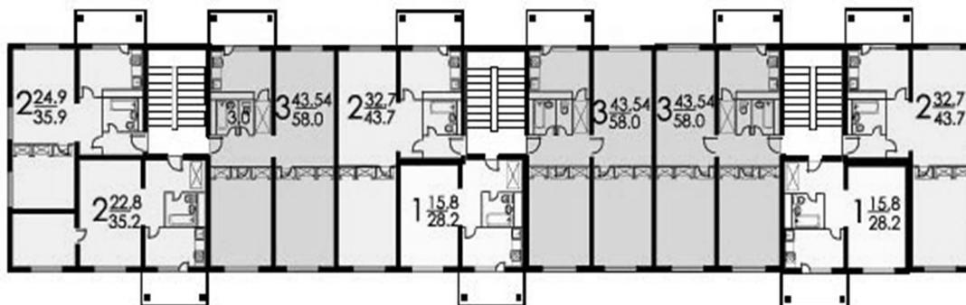
Рис. 1. Типовая планировка жилого дома серии П-32
