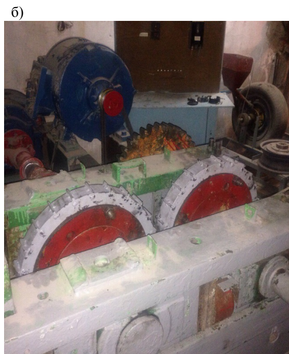
Рис. 1. Агрегат для получения кубовидного щебня с устройством для направленной подачи сланцевых материалов: а – вид на загрузочное устройство; б – вид на зубчатые валки
